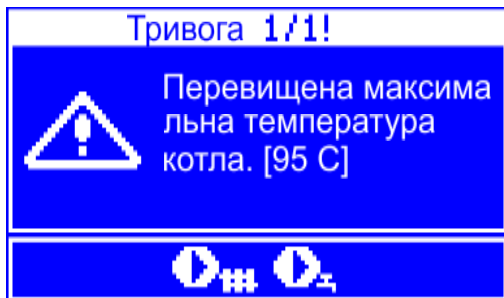
Мал.28 Вигляд тривоги перегріву котла.
