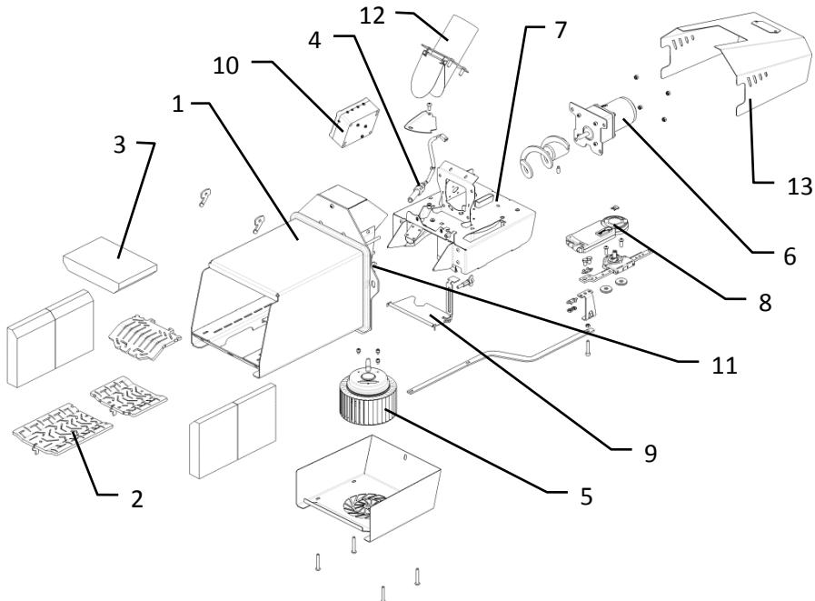
Рис.1 Элементы конструкции горелки STEHIO TERM
