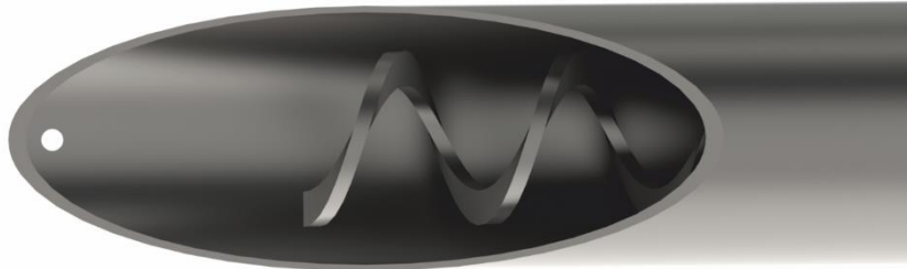
Рис.6. Монтаж спіралі подавача.
