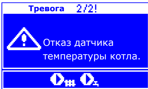
Рис. 30 Вид сигнала "повреждение датчика температуры котла".
