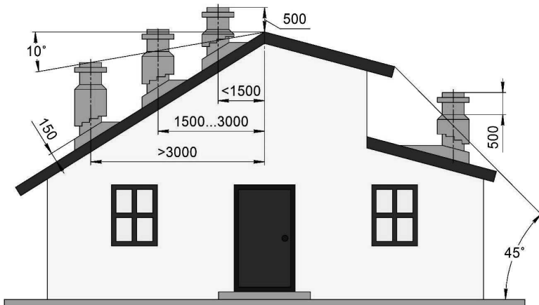
Рис. 6. Схема правильного вибору висоти димоходу над дахом
