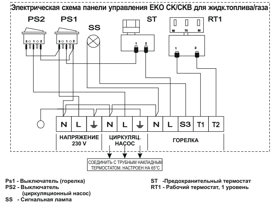
Рис 7. Электрическая схема панели управления ЕКО СК/СКВ для жидк.топлива/газа
